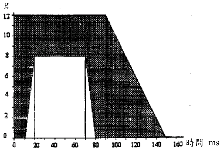
圖五：台車衝擊時之減速度或加速度
