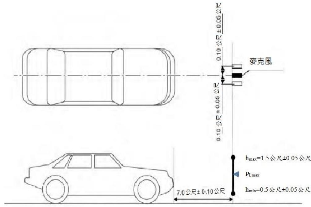
$h_{min}$ ：最低量測高度
