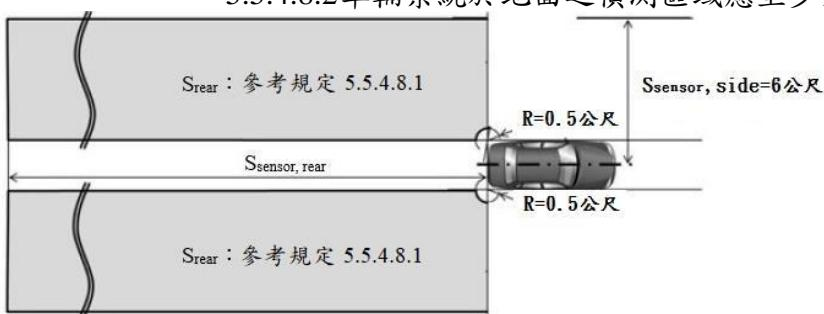
5.5.4.8.3 於車輛每次新引擎啟動/運轉循環後(非自動執行，例如：怠速熄火系統之作動)，ACSF 類型 C 功能應禁止車輛進行變換車道操控，直到系統至少偵測到一次距離大於規定 5.5.4.8.1 申請者所宣告之最短距離  $S_{rear}$  外之移動物體。
